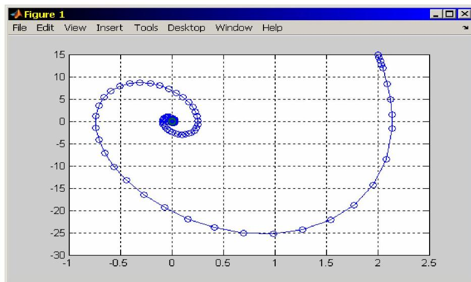
Рисунок 3 – Фазовая кривая динамики замкнутой системы ПЧ – АД
