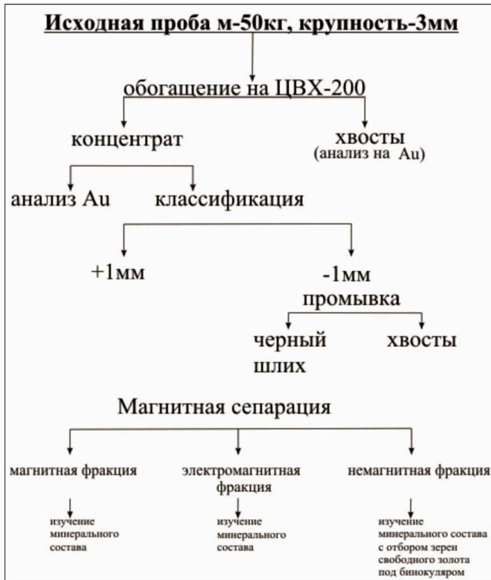
Рисунок 3 – Схема подготовки проб для изучения минерального состава
