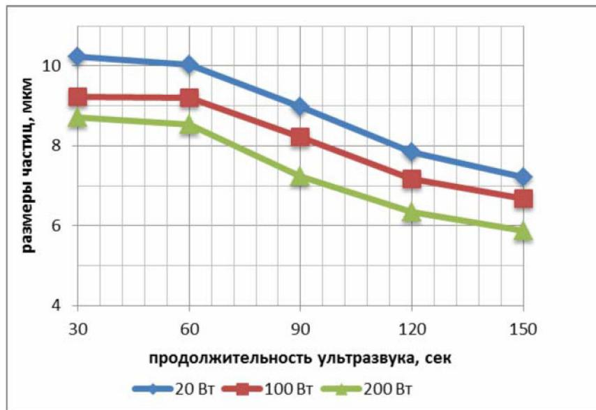
Рисунок – 1 Изменение размера частиц (в мкм) вкусо и пряно-ароматических ингредиентов от интенсивности воздействия ультразвука
