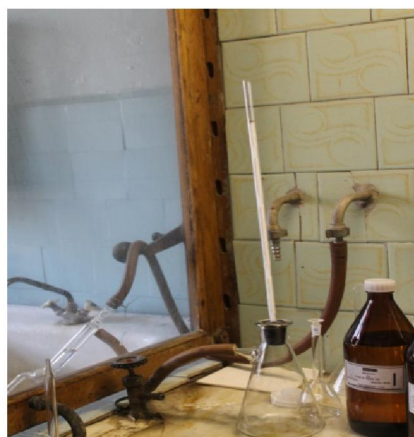
Рисунок 2 – Очистка на колонке с оксидом алюминия. Рисунок 3 – Высушивание образцов диоксина.
