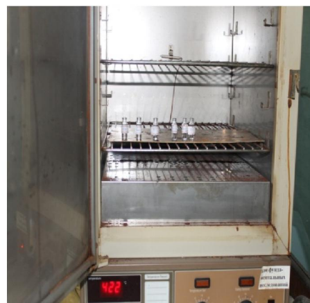
Рисунок 2 – Очистка на колонке с оксидом алюминия. Рисунок 3 – Высушивание образцов диоксина.
