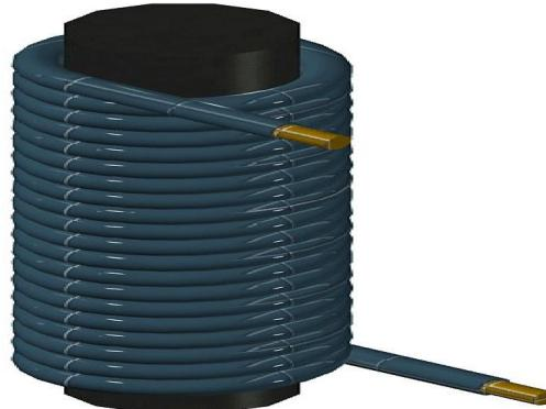
Рис. 4. Простейший электромагнит: вокруг ферромагнитного сердечника намотан электропровод в изоляции
