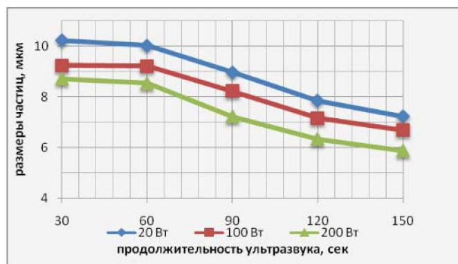
Рис. 1. Изменение размера частиц (в мкм) вкусо и пряно-ароматических ингредиентов от интенсивности воздействия ультразвука
