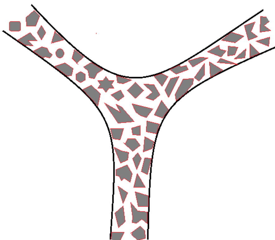
Сурет 1.8 - Үш фазалы көбік жүйесінің құрылымы
