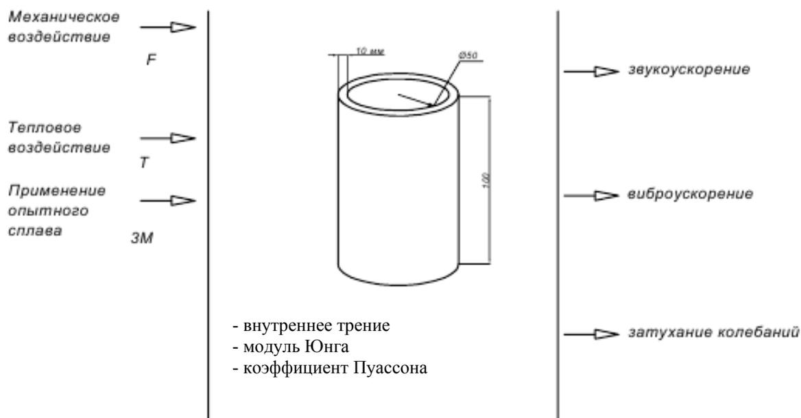
Рисунок Б1 - Постановка задачи моделирования цилиндрического образца (втулки) опытного сплава ЗМ
