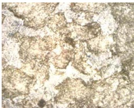
Рисунок 53 - Микроструктура сплава 2М (литье+ковка+нормализация)
