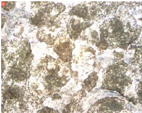
Рисунок 50 - Микроструктура сплава 1М (литье+ковка+закалка)
