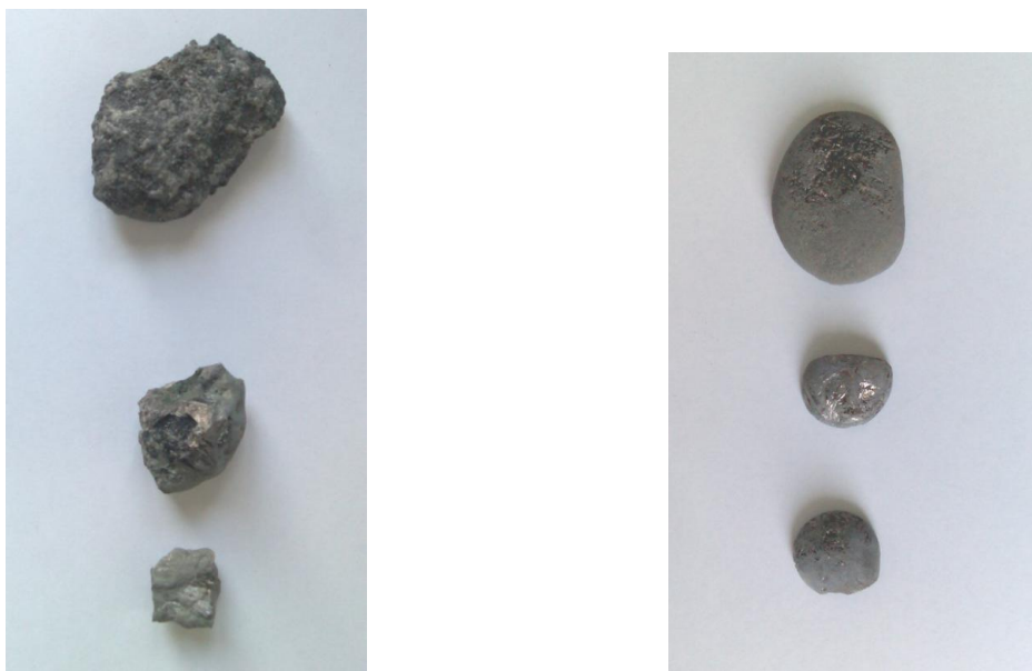
1 - фосфорный шлак, 2 – корольки феррофосфора с легирующими металлами
