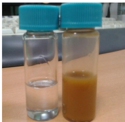
Рисунок 2.3 - Фотография образца люминесцирующего нанопорошка, полученного путем механического измельчения пленок ПК (на фото слева), полимер и суспензия с нанокристаллами кремния (на фото справа)
