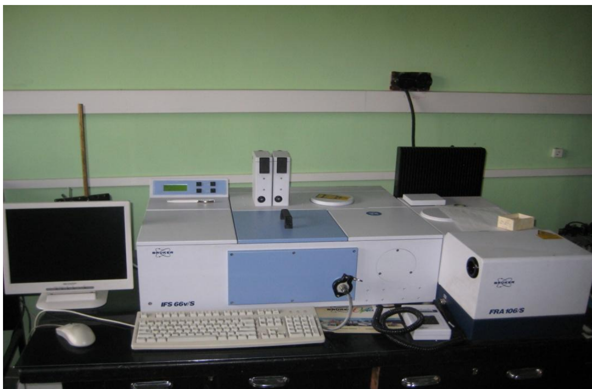
Рисунок 2.11 – Общий вид установки для измерения спектров отражения и пропускания в ближнем и среднем ИК диапазонах Bruker 66/vS
