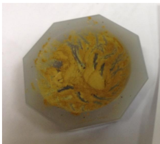
Рисунок 2.3 - Фотография образца люминесцирующего нанопорошка, полученного путем механического измельчения пленок ПК (на фото слева), полимер и суспензия с нанокристаллами кремния (на фото справа)
