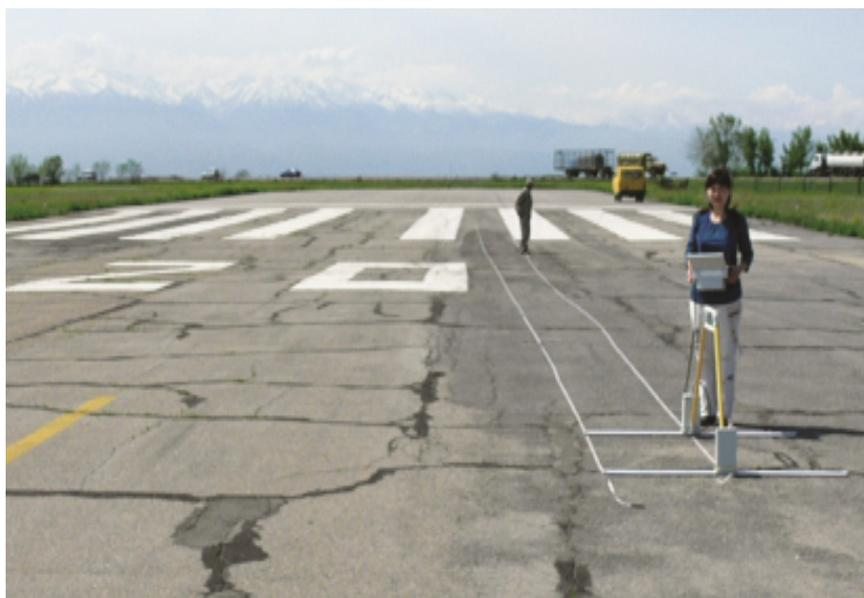
Рисунок В10 - Взлетно-посадочная полоса и георадар (эксперимент 2)
