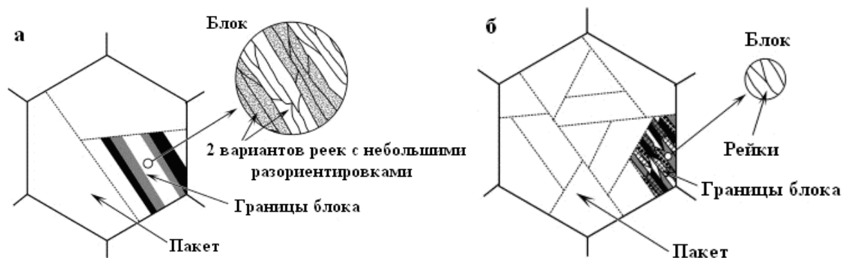
Рисунок 1.2- Схематические изображения пакетов сформированных из блоков, суб-блоков и реек (а) и (б) [19]
