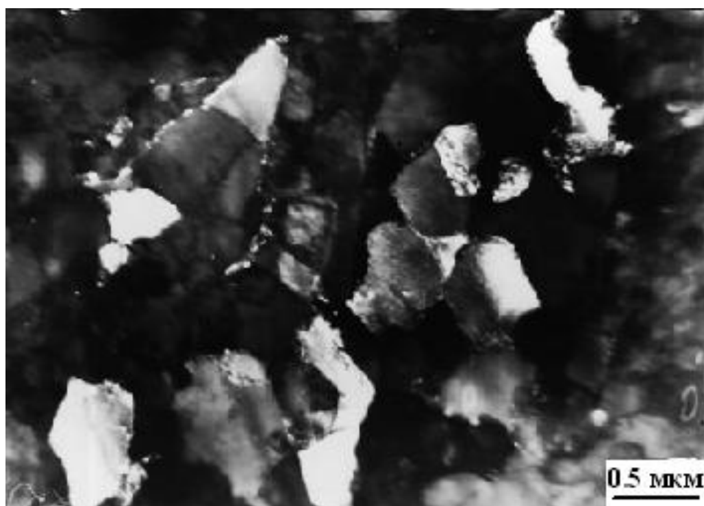
Рисунок 4.17- Темнопольные изображения фрагментированной субструктуры деформированной прокатом стали 30ХГСА на расстоянии 0.5 мм от поверхности валка. Границы фрагментов окаймлены выделениями специальных карбидов
