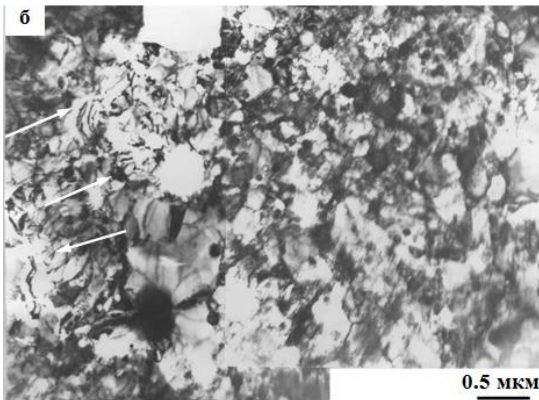
Рисунок 4.24- Микротрещины от первичных карбидов на поверхности валка деформированной прокатом стали 30ХГСА
