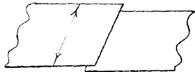
Фиг.9. Вариант соединения деталей внахлест с растягиванием 1 детали
