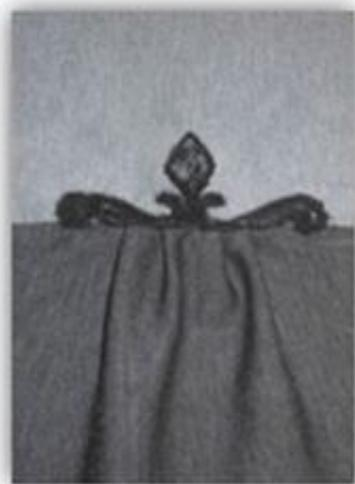
г) складки, сформированные при соединении иглопробивным способом
