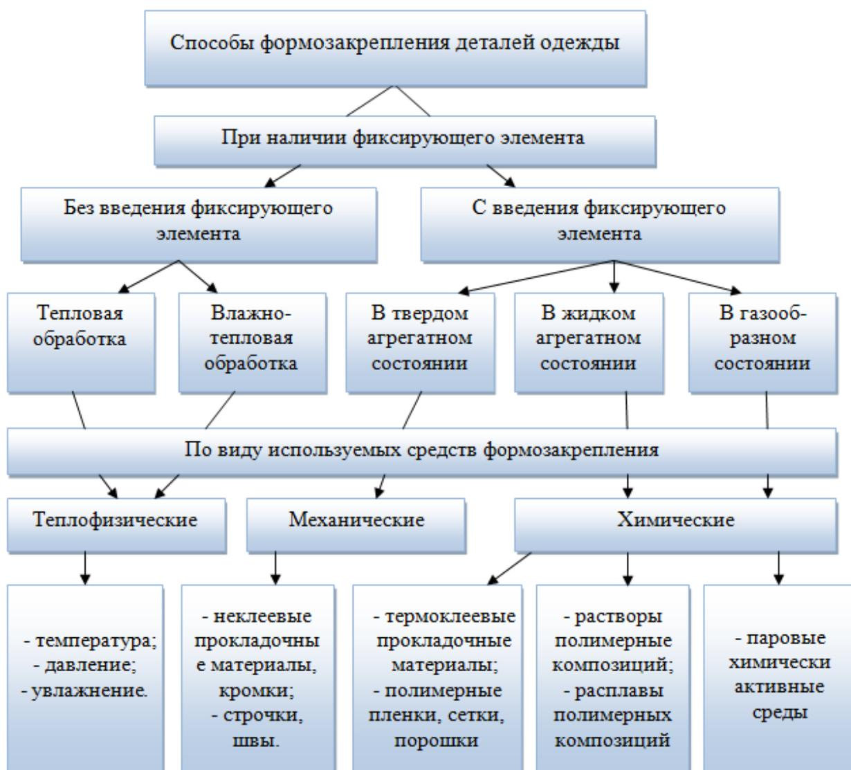
Рисунок 3 - Классификация способов формозакрепления деталей одежды
