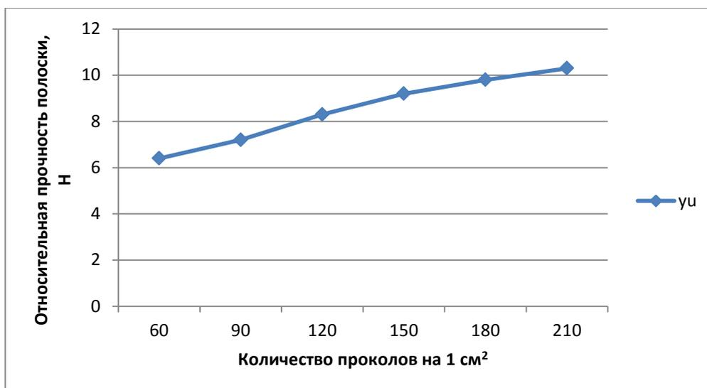
Рисунок 44 - Относительная прочность фелтинг-шва при растяжении вдоль петельного столбика переплетения: кулирная гладь (31x2x1 текс) модуль петли 16,5
