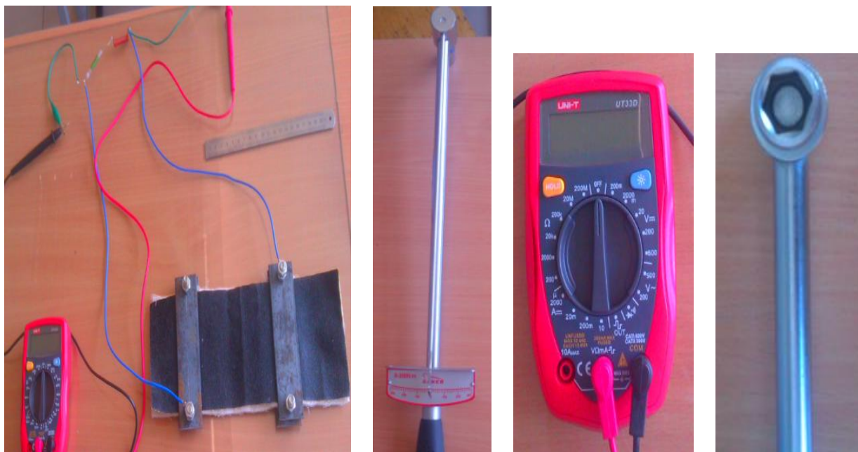
Сурет 3.13 - Электрлік кедергілерді анықтау құрылғысының сыртқы түрі
