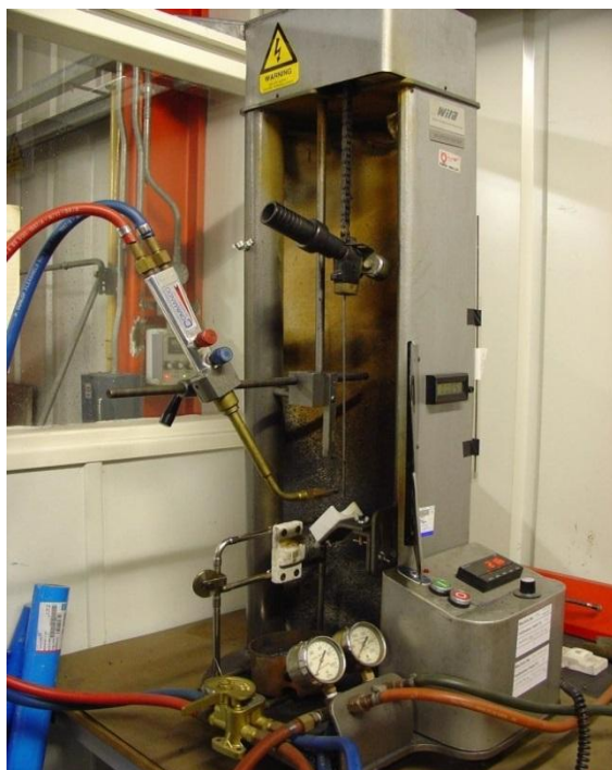
Сурет 3.22 –Балқыған металл тамшыларына материал төзімділігін анықтайтын құрылғы
