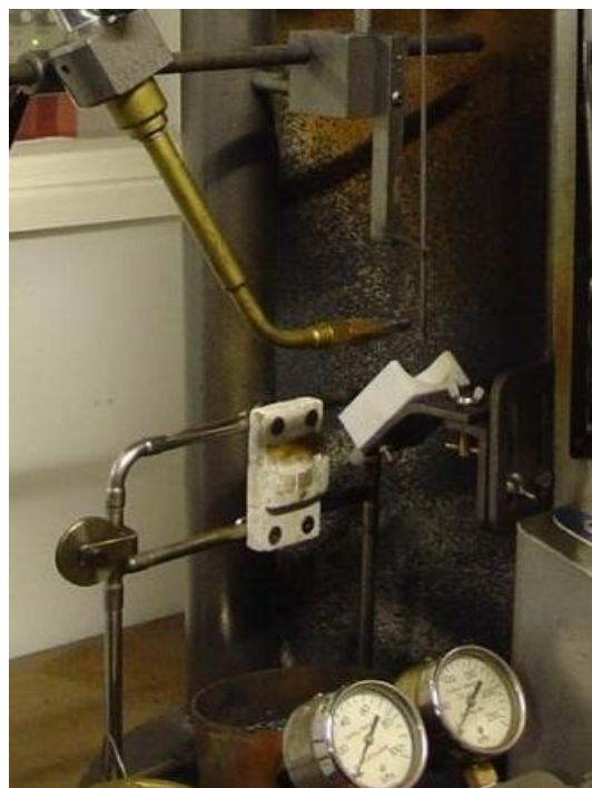
Сурет 3.22 –Балқыған металл тамшыларына материал төзімділігін анықтайтын құрылғы
