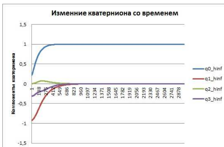
Рисунок 5.7 – Изменение углового положения МКА со временем, полученного в результате использования H_\infty -управления
