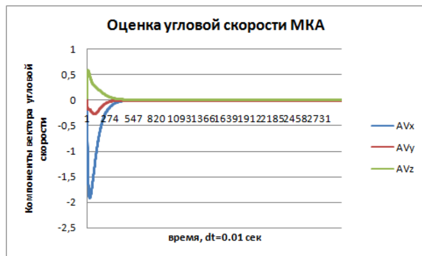
Рисунок 5.6 - Изменение угловой скорости МКА со временем, полученной в результате использования закона управления (3.22)
