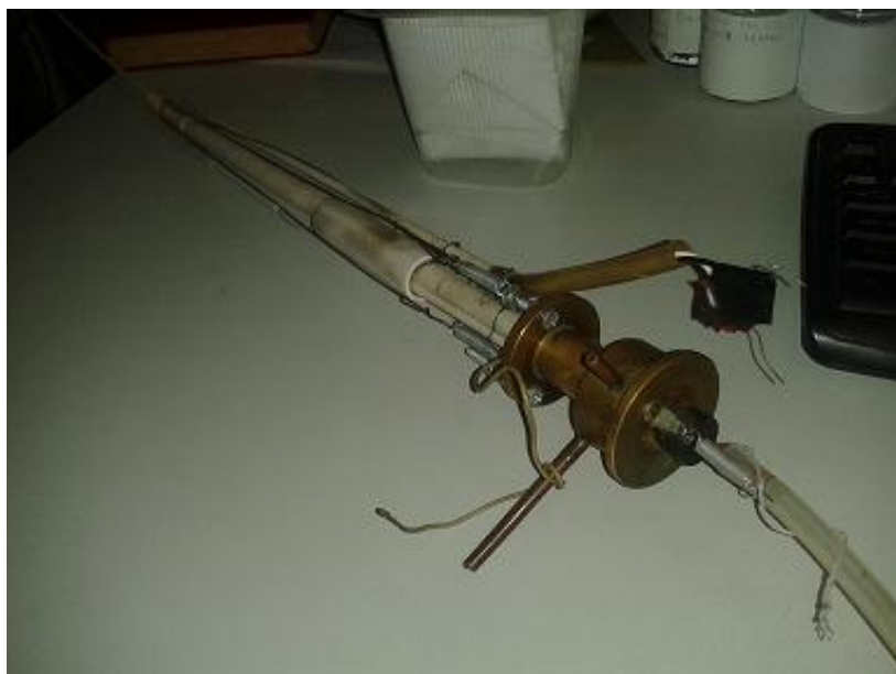
Рисунок 22 – Электрохимическая ячейка для исследования температурной зависимости электропроводимости сыпучих и твердых материалов
