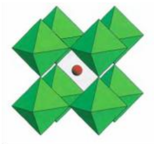
Рисунок 2 - Полиэдрическая модель неискаженной структуры перовскита
