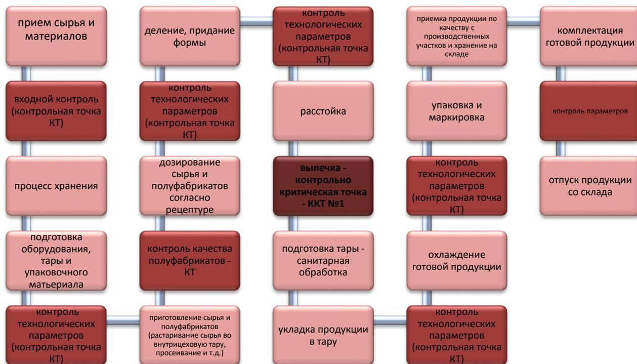
Рисунок 35 - Блок схема процесса производства
