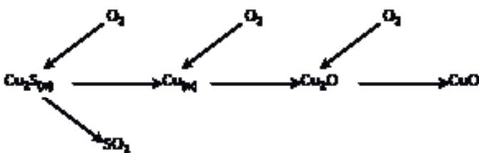
На начальном этапе второй стадии окисления образца одновременно с растворением кислорода в медном расплаве происходят окисление растворенной в нем серы и переход последней в газовую fazу по схеме:
