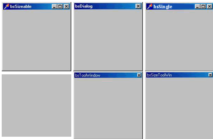
Рис.38. Влияние значения BorderStyle на вид Формы. Значения по часовой стрелке, начиная с левой верхней Формы, таковы: bsSizeable, bsDialog, bsSingle, bsNone, bsToolWindow и bsSizeToolWin.
