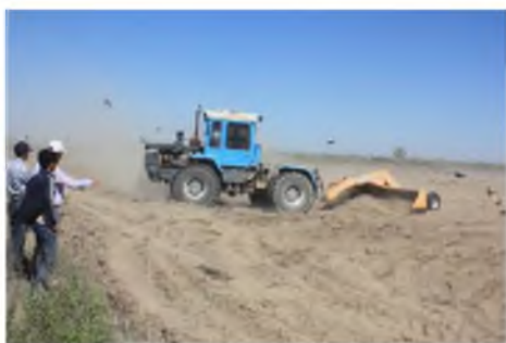
Рисунок 5 – Культурно-технические работы и планировка чеков
