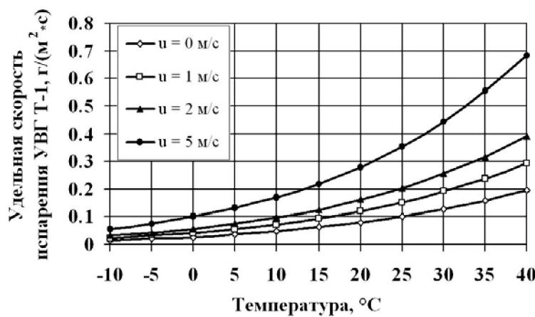
Зависимость удельной скорости испарения горючего Т-1 от температуры окружающей среды и скорости ветра [22]
