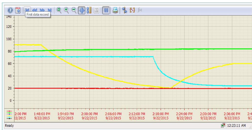
Рисунок 2.6 – График экспериментального снижения уровня выпелачивающих растворов в закачной скважине и ее заполнения при увеличении расхода.
