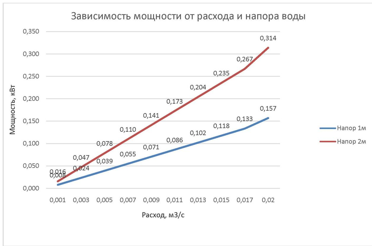
Рисунок 3 – График зависимости мощности от расхода и напора воды (при  $H = 1, 2 \text{ м}$ )
