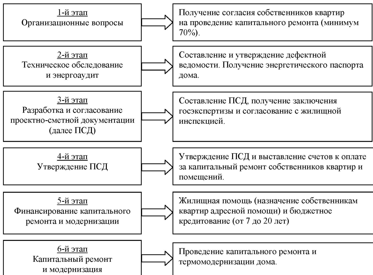
Рисунок 2 – Этапы проведения капитального ремонта и модернизации МЖД
