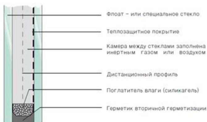
Рис.1. Структурный стеклопакет
