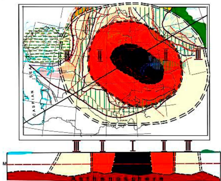
Рисунок 2 – Схематическое строение континента «Казахия»: I – внутреннее кольцо; II – среднее кольцо; III – внешнее кольцо (составлено на основе схемы тектонического районирования палеозойд Казахстана)
