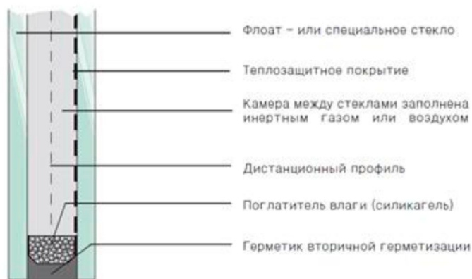
Рис.1. Структурный стеклопакет
