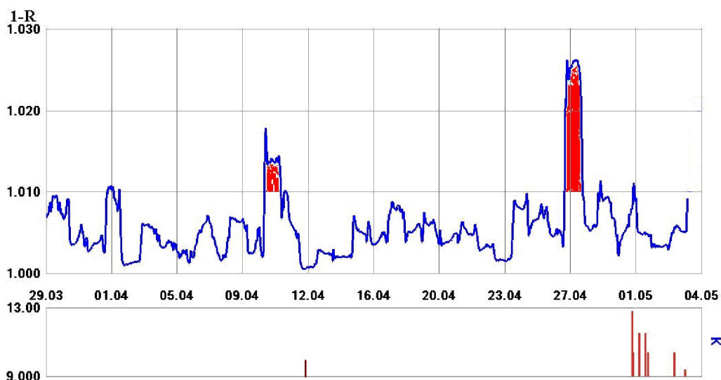
Рисунок 7 – График 1-минутных значений корреляционной функции модуля Т геомагнитного поля между МВС «Тургень» и «Курты» в апреле 2011 г.
