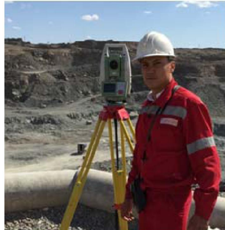
5-сурет – а – Ақбақай зонасына кіретін «Карьерное» кенорнының жалпы көрінісі; ә – электронды тахеометрмен карьер қиябеттерін түсіру
