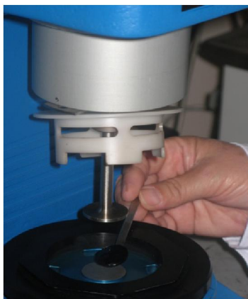
Рисунок 6 – Испытание битумного вяжущего в реометре динамического сдвига (DSR)
