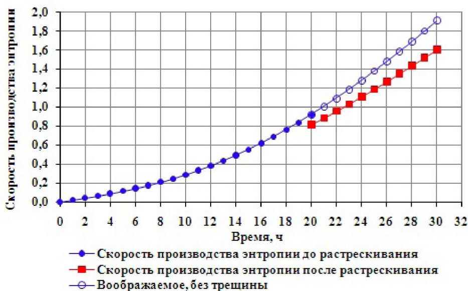
Рисунок 22 – Изменение скорости производства энтропии до и после растрескивания асфальтобетонного покрытия
