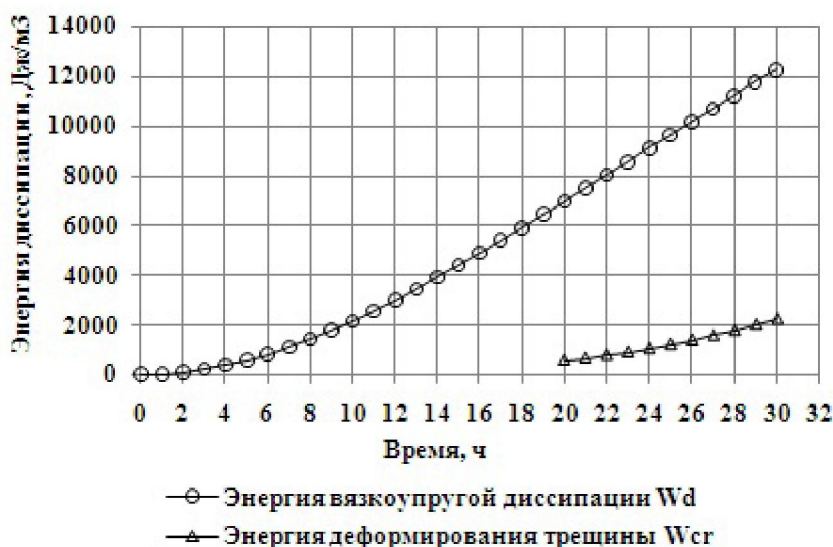
Рисунок 13 – Изменение энергий вязкоупругой диссипации асфальтобетона ( W_d ) и деформирования трещины ( W_{cr} )
