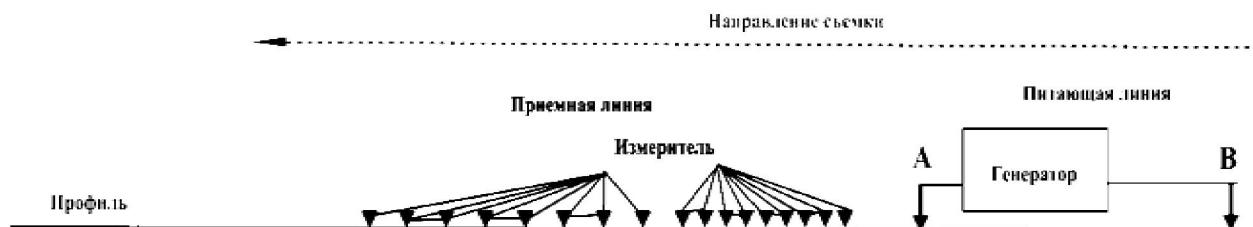
Рисунок 1 – Схема системы генератор-приемник
