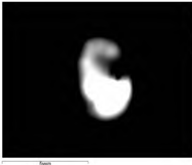
Рисунок 1 – Микроразмерное зерно амальгамы серебра в V 4+ -Ba-фенгите. Углеродисто-кремнистые сланцы. Баласаускандык. Изображение полированной поверхности в обратнорассеянных электронах (состав). Аналитик В. Л. Левин
