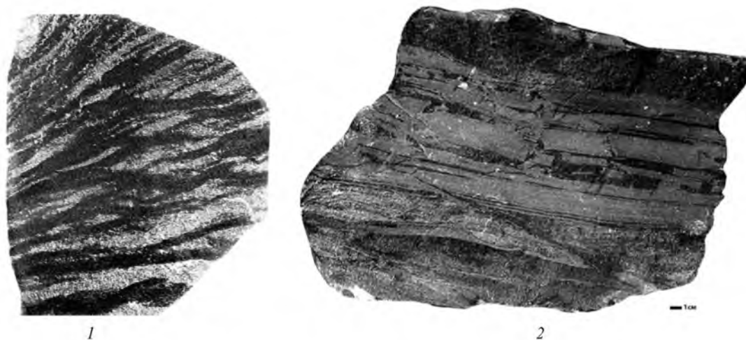
Рисунок 5 – Примеры инъекционных структур: 1 – струйчатые текстуры: струи борнита (темное) пересекают песчаник с галенитовым оруденением. Полированный шлиф – натуральная величина; 2 – фрагмент рудного пласта
