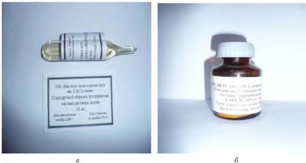
Рисунок 1 – Стандартные образцы предприятия состава раствора осмия (а) и перрената аммония (б) Figure 1 – Standard enterprise composition samples of the osmium solution (a) and ammonium perrhenate (b)
