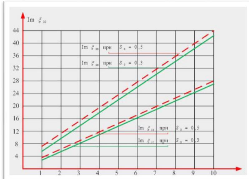
Рисунок 2- влияние времени релаксации на частоту  $\text{Im}\xi_j$  собственных колебаний
