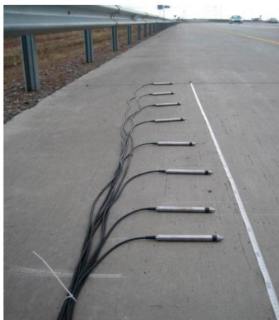
Рисунок 9. Один комплект датчиков температуры и влажности
