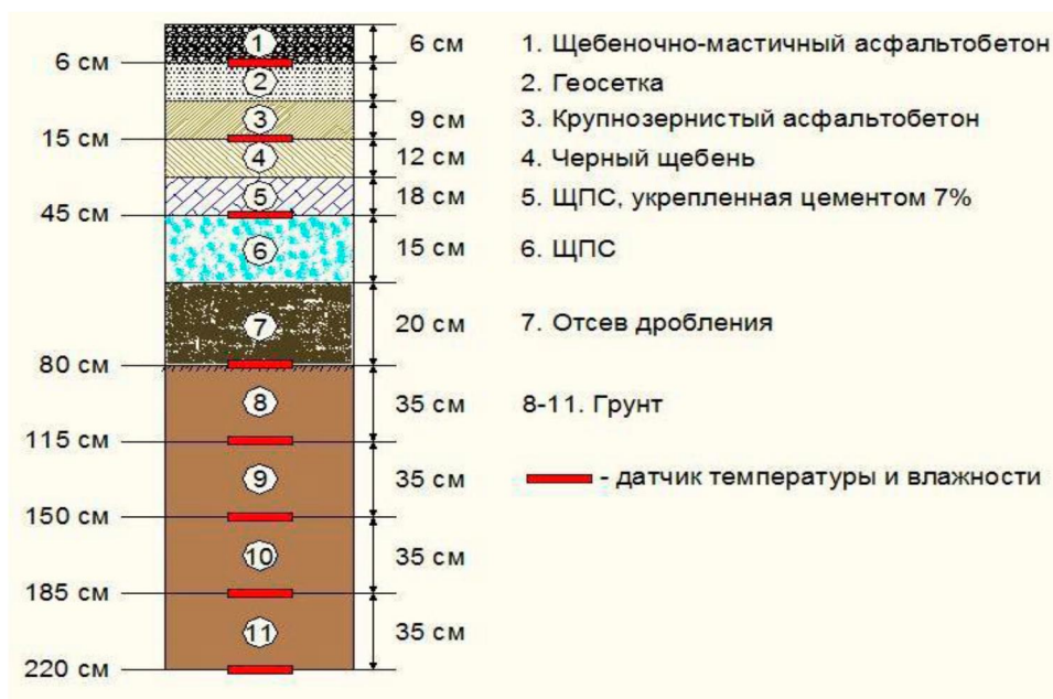
Рисунок 11. Схема расположения датчиков в дорожной конструкции
