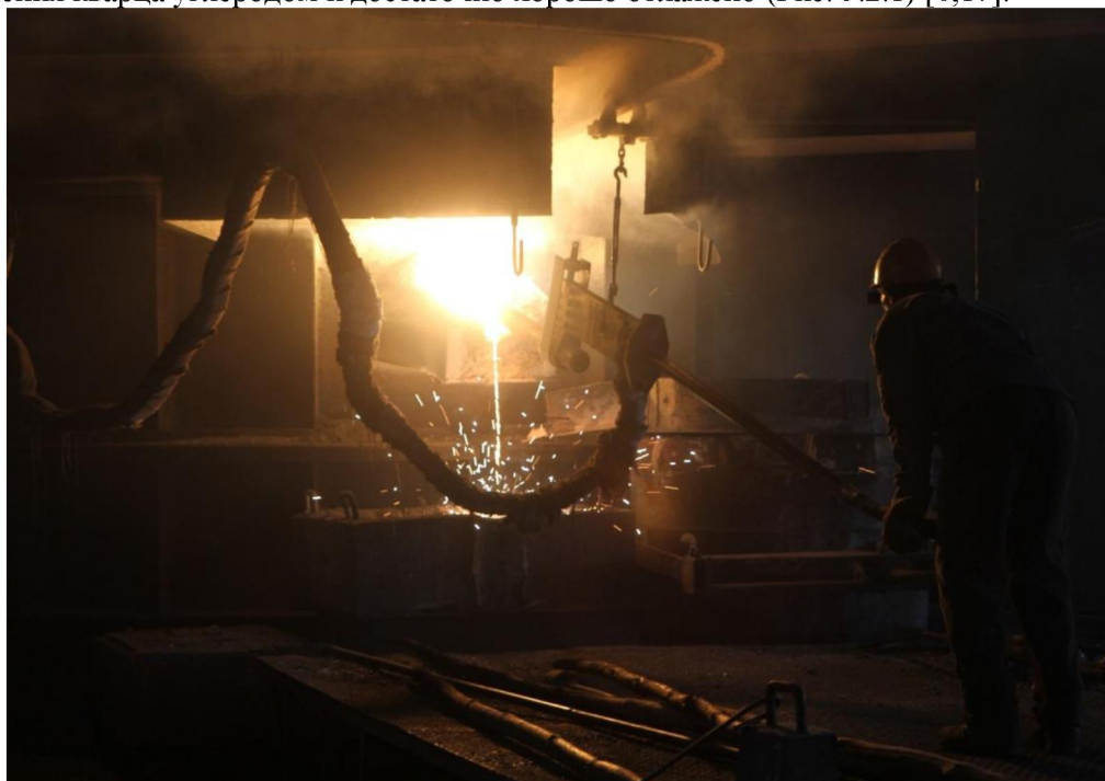
Рис. 5.2.1 Электродуговая печь и процесс получения МК на предприятии Казсилкон (см. текст).
