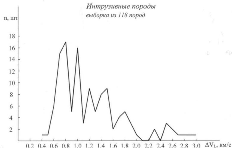
Рисунок 1 - Гистограмма изменения скорости ( $\Delta V_L = V_p - V_{ucx}$ ) продольных волн при давлении 10 000 кгс
