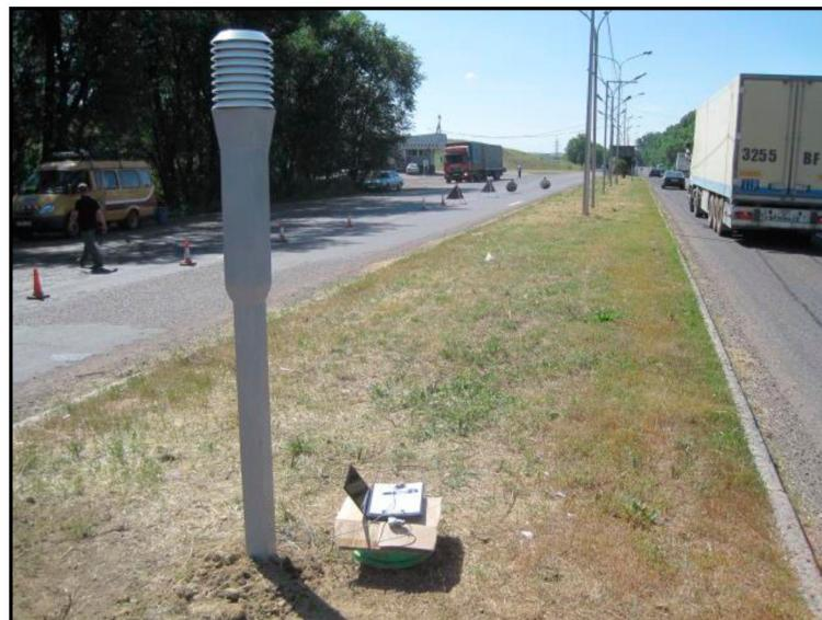
Рисунок 3. Вид наземной части системы автоматического измерения температуры и влажности
