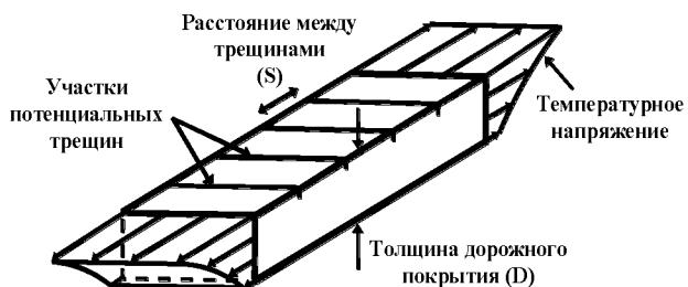
Рисунок 2. Схема физической модели участка дорожного покрытия
