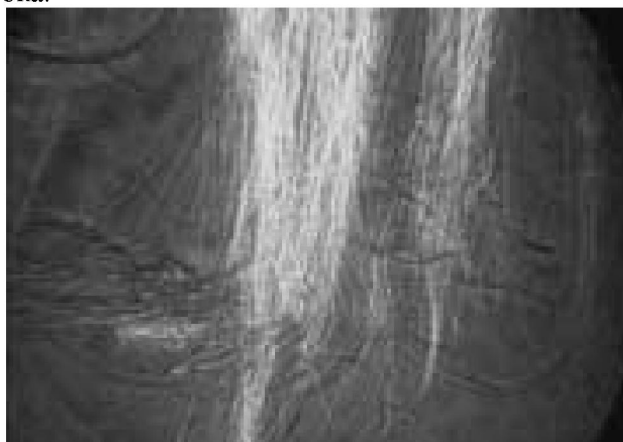
Рисунок 5 - Микрофотография экструдата 18%-ного смесового раствора в ММО (25 % целлюлозы и 75 % ПМФИА) после удаления растворителя и растворения полиамидной фазы в ДМФА
