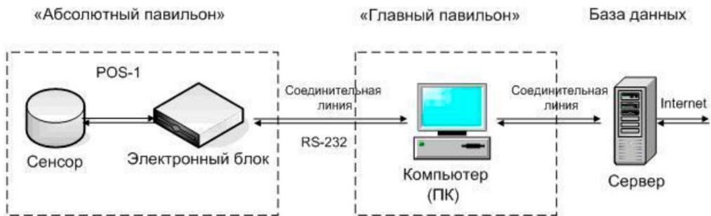
Рисунок 1 – Схема соединения аппаратуры
