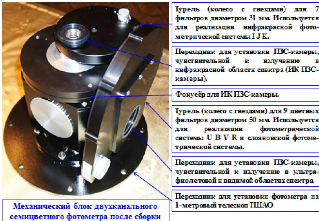
Рисунок 2 – Механический блок двухканального фотометра
