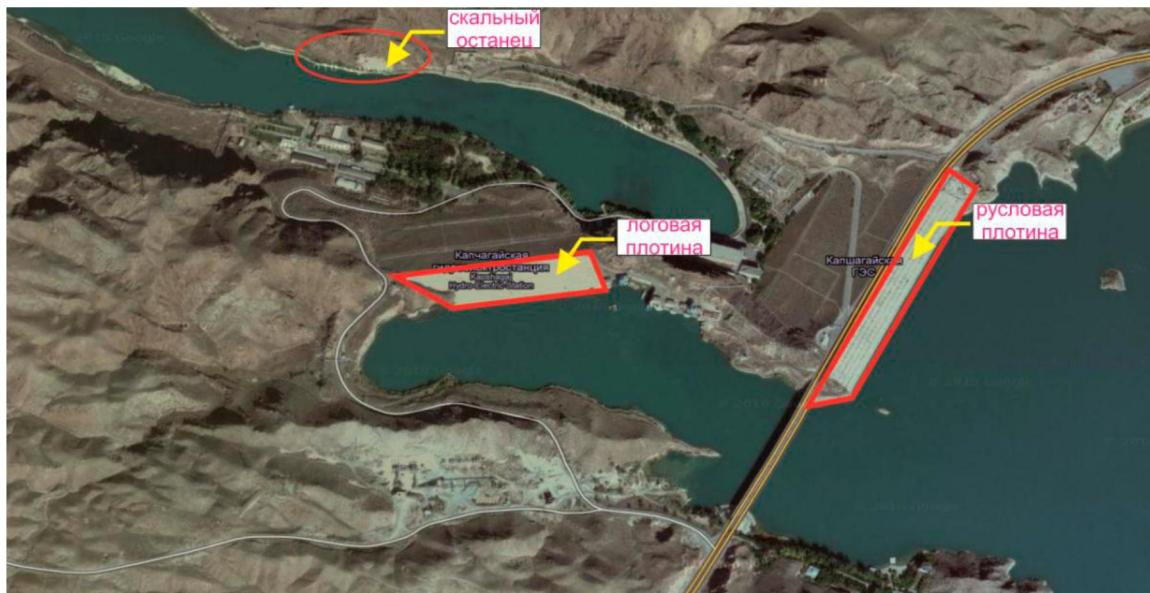
Рисунок 1 – Космический снимок гидротехнических сооружений Капчагайской ГЭС
