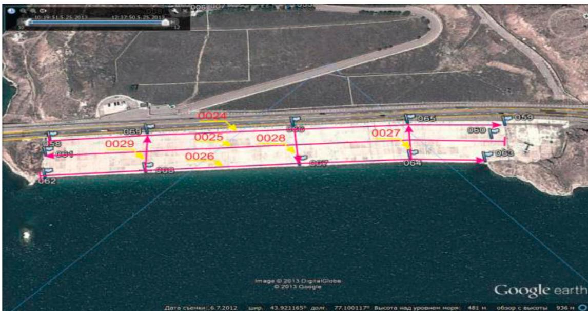
Рисунок 2 – Русловая плотина с продольными и поперечными георадарными профилями.
