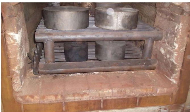
Рисунок 2 - Электрическая печь для обжига металлических блочных катализаторов на опытно-экспериментальном участке АО «ИТКЭ»
