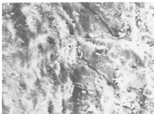
Рисунок 5-Электронно-микроскопический снимок -γ-Al 2 O 3
