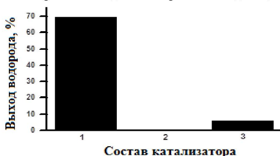
Обозначения: 1 – 1%MoCrGa/ТБГ; 2 – 10% MoCrGa/ТБГ; 3- 5% MoCrGa/ТГ+ZSM-5+Al n (OH) 3n-1 NO 3 . Рисунок 4 - Влияние состава активной фазы катализатора на выход водорода при C 3 -C 4 УВ:O 2 :N 2 :Ar=0,95:1:3,76:0,95, T=550 0 С, V=3150 ч -1
