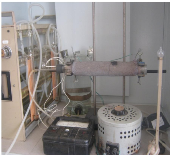
Рисунок 1 – Установка по термическому пиролизу углеродных материалов в среде пропан бутанового газа
