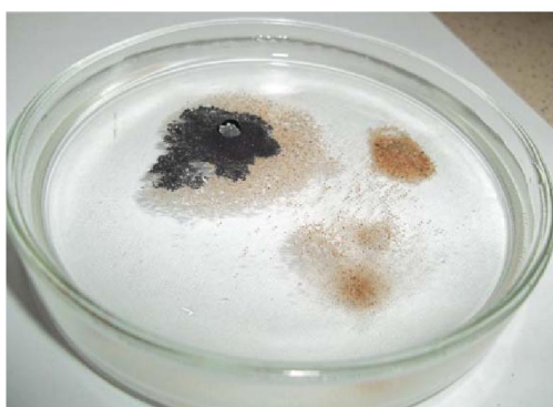
10-сурет – Су бетіндегі құмның әрекеті: қарапайым құм, полиуретанмен қапталған құм, гидрофобты құм
