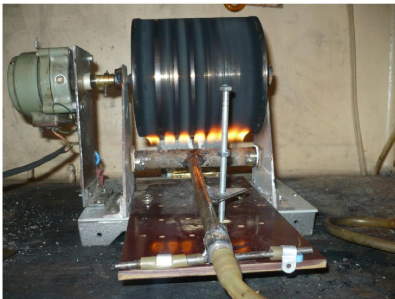
6-сурет – Электр өрісінің реттелуімен супергидрофобты күйені синтездеу процесінің тәжірибелік қондырғысының фотосуреті
